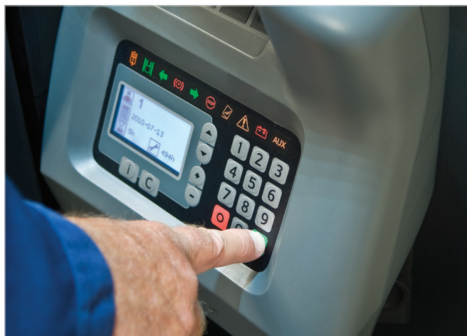
A hozzáférés-szabályozó funkció megelőzi a gép illetéktelen személyek általi használatát, és lehetővé teszi az egyes gépkezelők személyes paramétereinek beállítását a targonca indításakor.
