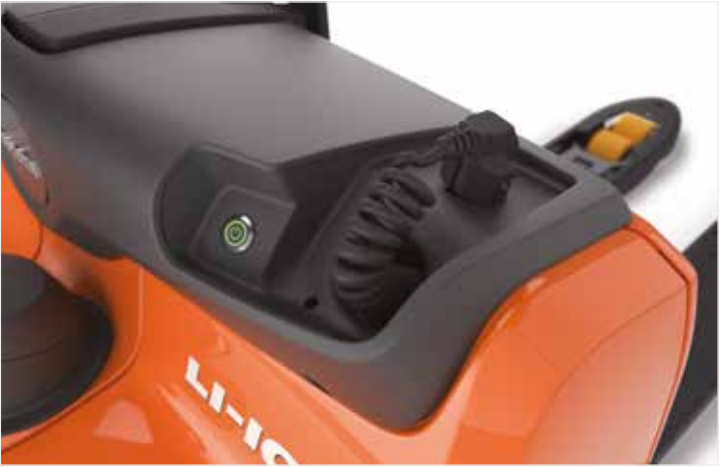
Könnyű és gyors töltés a beépített töltővel (külső töltővel is rendelhető).
