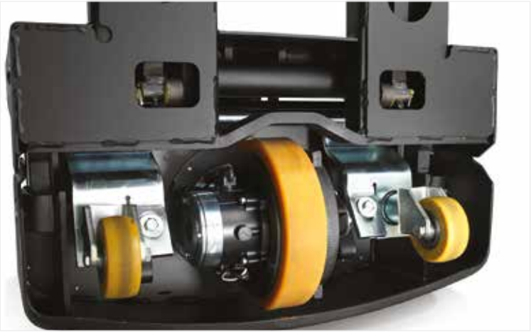
Egyetlen felületen az egyedülálló Castorlink rendszer gondoskodik a futógörgők védelméről
