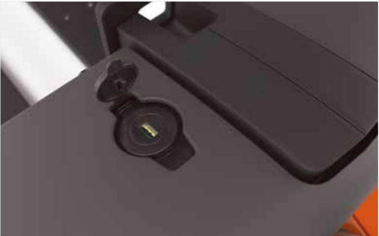
5V USB csatlakozó telefonok, tabletek, egyéb külső egységek töltéséhez.
